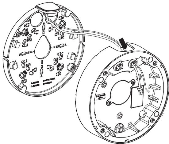
2-3. Die Kabeleinführung am Kameragehäuse anbringen.
