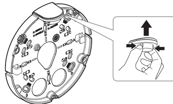
2-3. Das Rohr auf der Befestigungsplatte positionieren.
