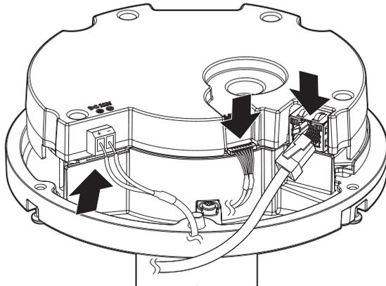
3. Das Kameragehäuse mit der Bodenabdeckung verbinden.
