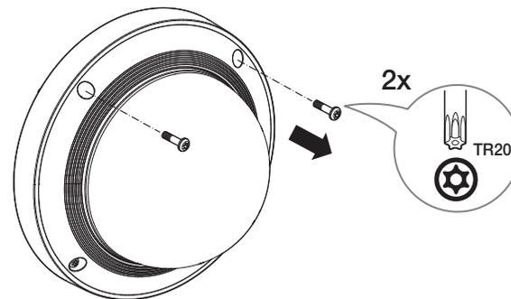
2. Die Kuppelabdeckung montieren.
