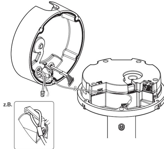
2. Die Netzwerk-/Stromversorgungs-/Audio-/Alarmkabel am Anschluss des Kameramoduls anschließen.
