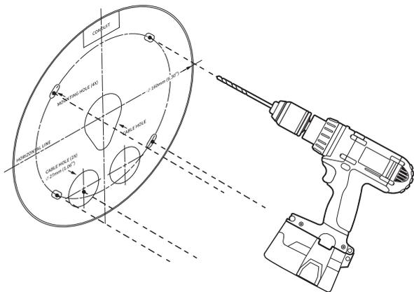
1-2. Die Befestigungsplatte mit den entsprechenden Schrauben befestigen.
