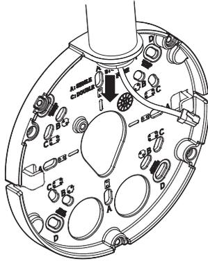
1-4. Die Kabeleinführung an der unteren Abdeckung anbringen.
