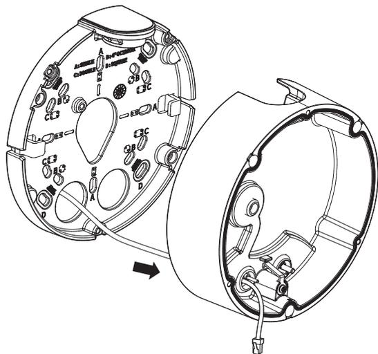
4. Die Befestigungsplatte mit der unteren Abdeckung verbinden.
