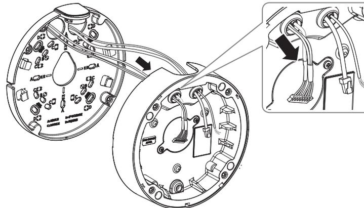
4. Die Befestigungsplatte am Kameragehäuse anbringen.
