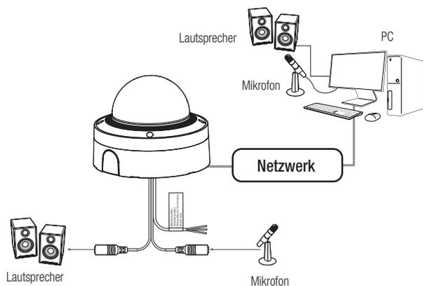
1. Verbinden Sie den MIC Anschluss der Kamera mit dem Mikrofon oder dem LINE OUT Anschluss des Verstärkers, an den das Mikrofon angeschlossen ist.
