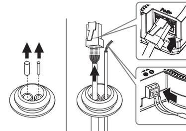
1-4. Die Kabeleinführung am Kameragehäuse anbringen.
