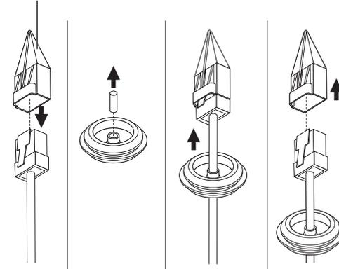
2-3. Die Kabeleinführung an der unteren Abdeckung anbringen.
